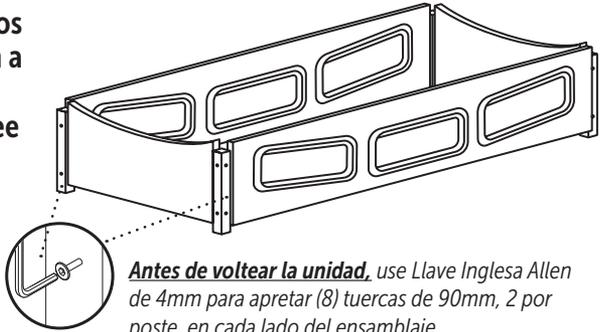
Antes de voltear la unidad, use Llave Inglesa Allen de 4mm para apretar (8) tuercas de 90mm, 2 por poste, en cada lado del ensamblaje.
