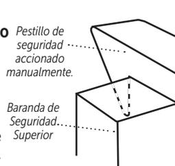
Este pestillo debe montarse correctamente en la extensión para garantizar que la baranda de seguridad superior se mantenga firmemente en su lugar.
